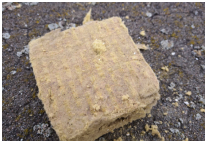
Foto /56/ Pohled na tepelnou izolaci z minerální vaty
