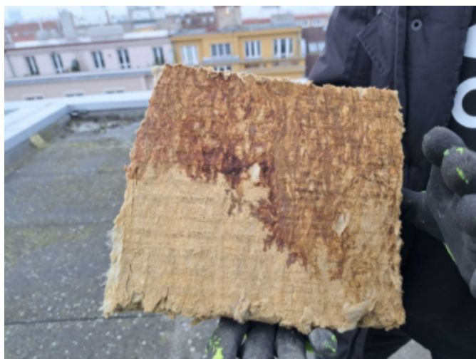
Foto /57/ Silně navlhnutá tepelná izolace z minerální vaty ze sondy S2
